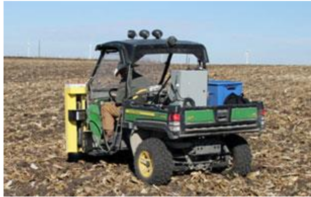
Фигура 2. Вземане на проби в голямо поле с хидравлично оборудване за вземане на проби.
