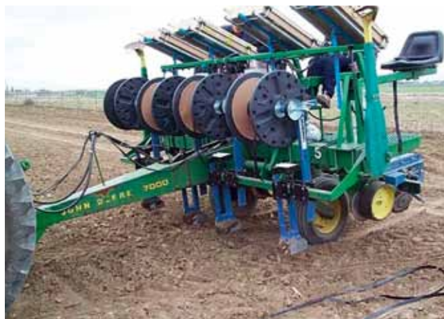
Ріонеер регулира почвената влага в управляваните стресови среди с прецизно капково напояване. Макари с маркучи за капково напояване са монтирани върху сеялката за изпитвания.
