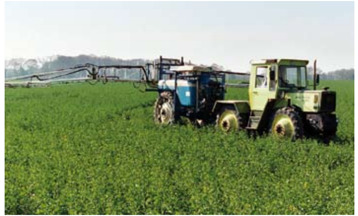
Bei einer optimierten Technik mit hohen Arbeitsbreiten und einer hohen Bodenfreiheit bei Schlepper und Feldspritze sind die Fahrgassenverluste geringer (Fotos: Dr. Wolfgang Sauermann)
