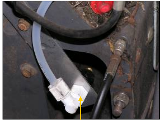
Claas: Düse am Ansaugloch positioniert
