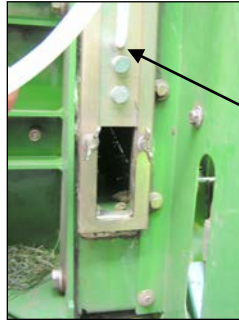
Krone: Position der Düse am Ansaugloch
