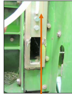
Krone: Position der Düse am Ansaugloch
