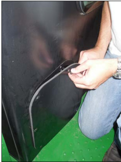
Klappe rechte Fahrerkabine öffnen
