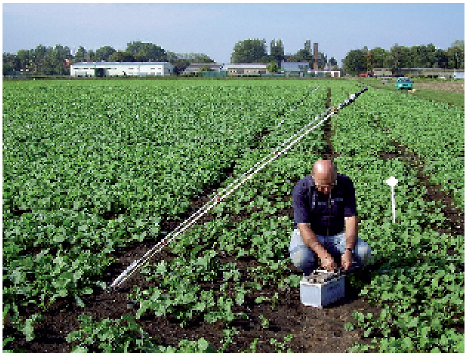
Abb. 1: Minirhizotron zur Wurzelbeobachtung
