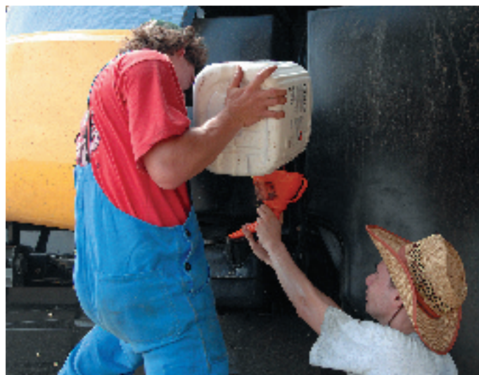
Kraftstoffverbrauchsmessung im separaten Tank
