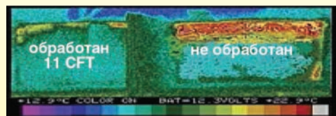
Рис. 2. Фотография распределения температур в силосе, обработанном инокулянтом Pioneer 11CFT, и без обработки
