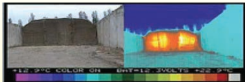
Рис. 2. Фотография распределения температур в силосе, обработанном инокулянтом Pioneer 11CFT, и без обработки
