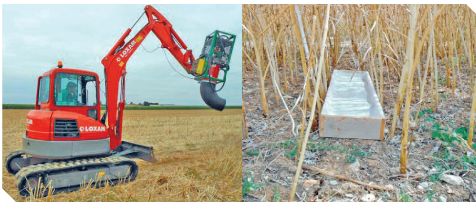
A becőpattanás elleni ellenállás vizsgálata szántóföldi körülmények között. A szélviszonyokat szimuláló, kísérleti mezőgazdasági légfúvó és a kipattanó magvak gyűjtőedénye (fotó – DuPont Pioneer)
