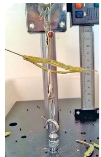
A becőpattanás elleni ellenállás vizsgálata laboratóriumi körülmények között. Berendezés a repcebecő pattanásához szükséges erő nagyságának mérésére. (fotó – DuPont Pioneer)
