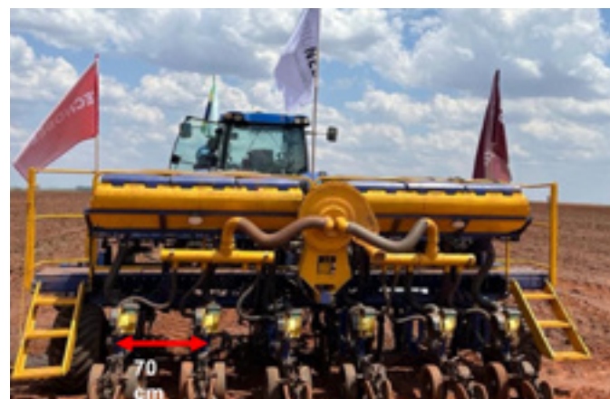
Imagem 9: semeadora adaptada para plantio em reforma de cana com espaçamento de 70 cm entre linhas, visando maior vazão de palha nas áreas de palhada crua. Foto: Rodrigo Matos, 2022
