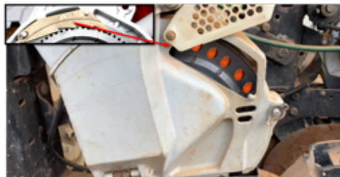
Imagem 8: dosadores mais antigos, que dependem de regulagem a cada troca de peneira e lote de sementes. Singuladores conhecidos como “jacarés”. Foto: Ronaldo Gonzaga, 2023
